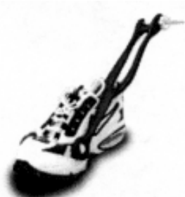
รูปที่ 4 แสดงการขยายหนังของรองเท้าเฉพาะจุดโดยการใช้ ball and ring stretcher
