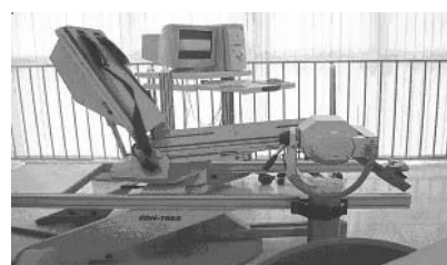
รูปที่ 2 เครื่องวัดกำลังกล้ามเนื้อแบบไอโซโคเนติก รุ่น Contrex-MJ
